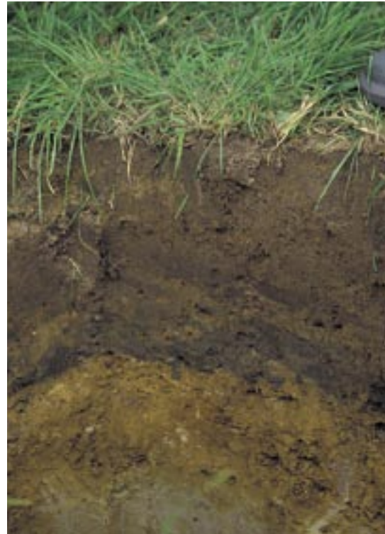
Een eerste beoordeling van de bodemstructuur begint met een bodemprofiel.
